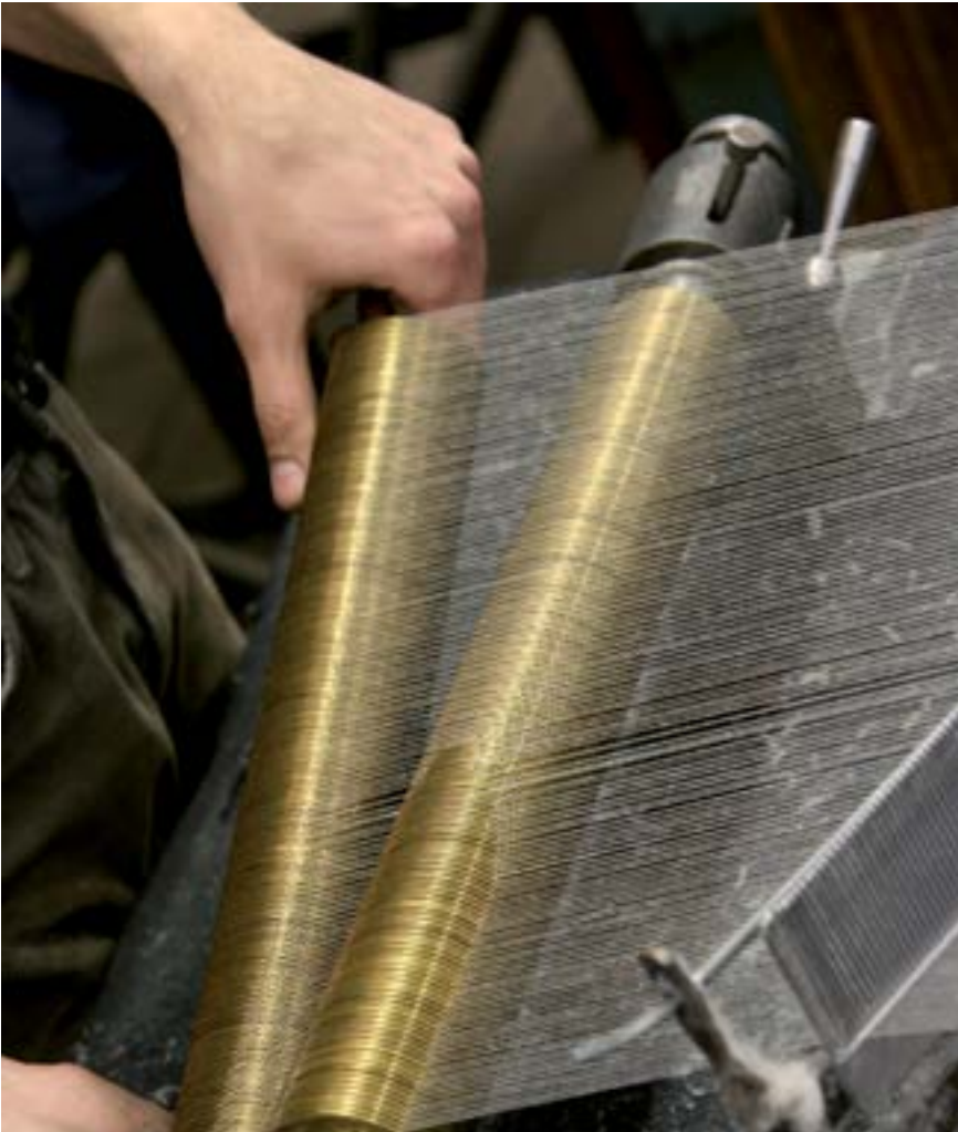
Winding of the empty bobbins Füllen der leeren Bobinen Remplissage des bobines vides
