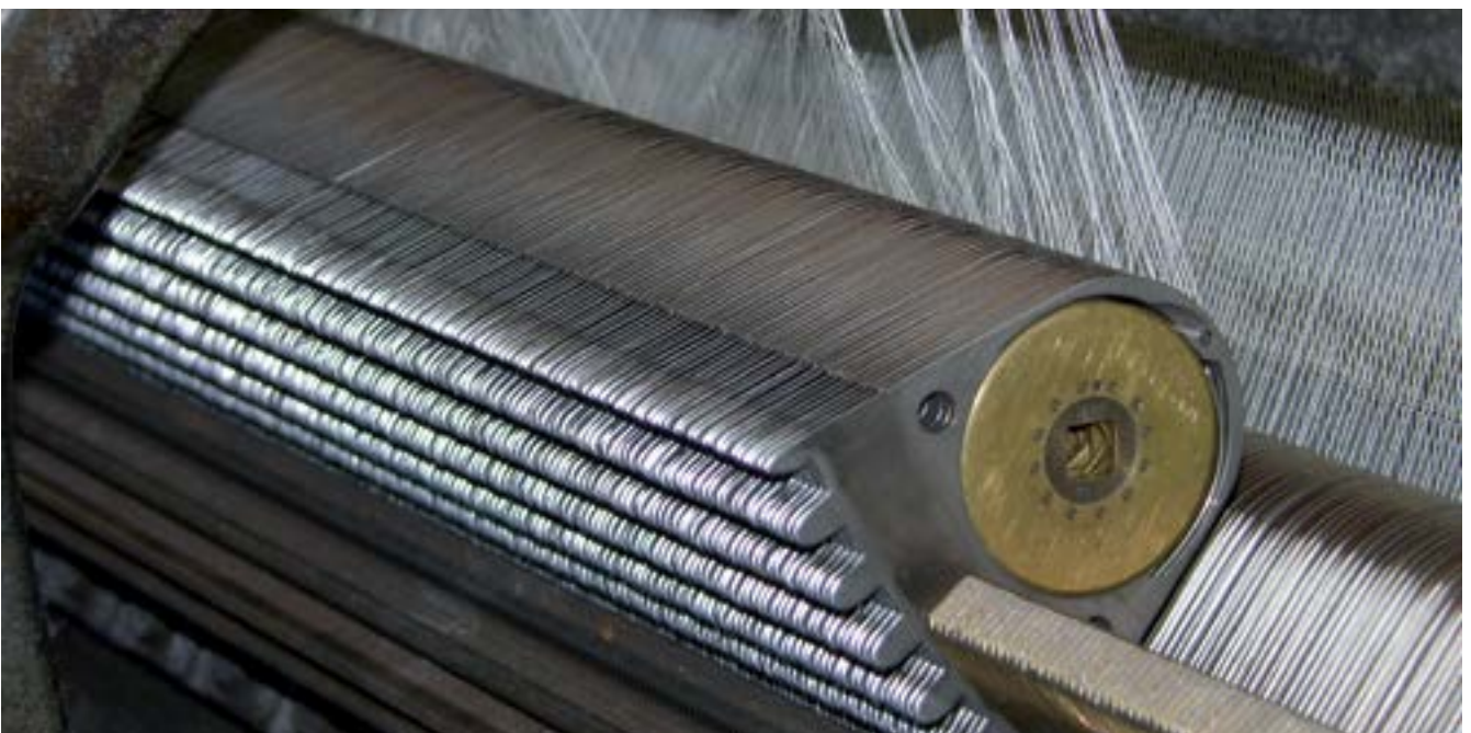
Insertion of the wound shuttles into the shuttle paths Einlegen der gefüllten Schützen in die Schützenbahn Mise en place des canettes pleines dans les navettes
