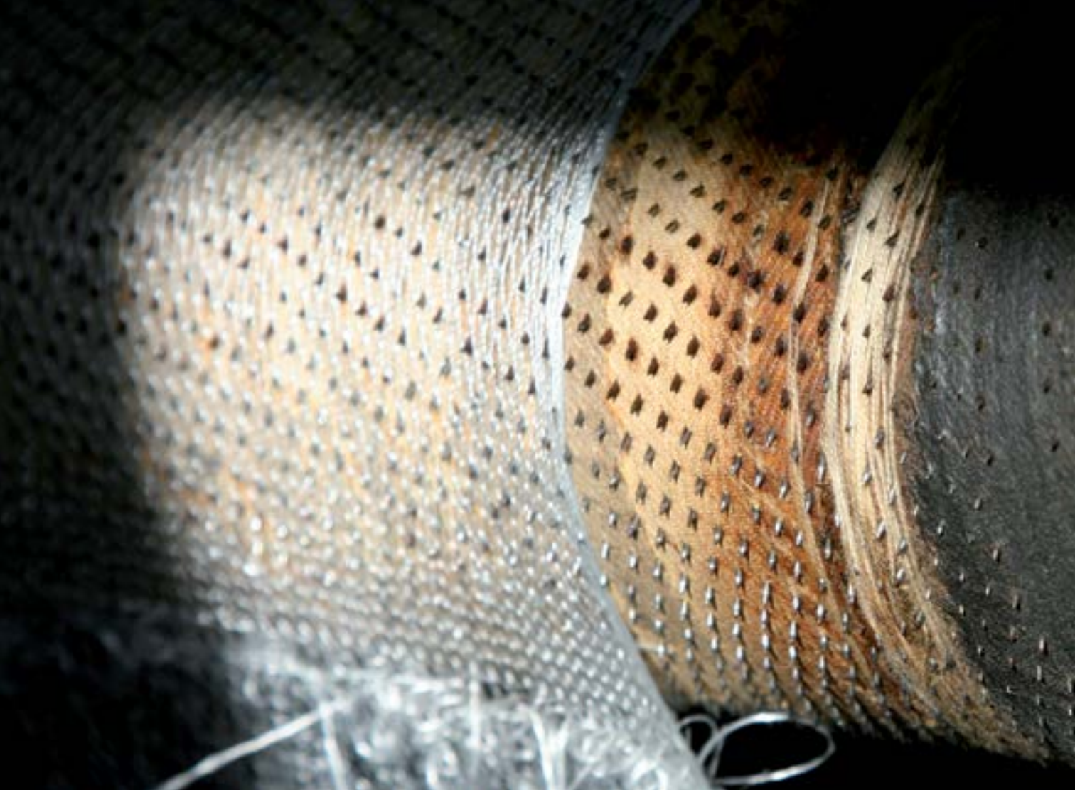
Porcupine roller Abzugs-Kratze Carde
