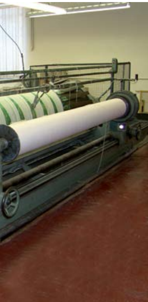
Warp creel for the creation of the warp beam Spulengatter für die Herstellung des Kettbaumes Cantre à bobineaux pour la fabrication de l'ensouple
