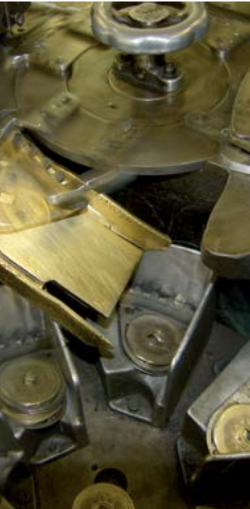
Insertion of the wound brass bobbins into the shuttles made of plate Einsetzen von gefüllten Bobinen (aus Messing) in die Schützen (aus Blech) Mise en place des bobines pleines (en laiton) dans les canettes (en tôle)
