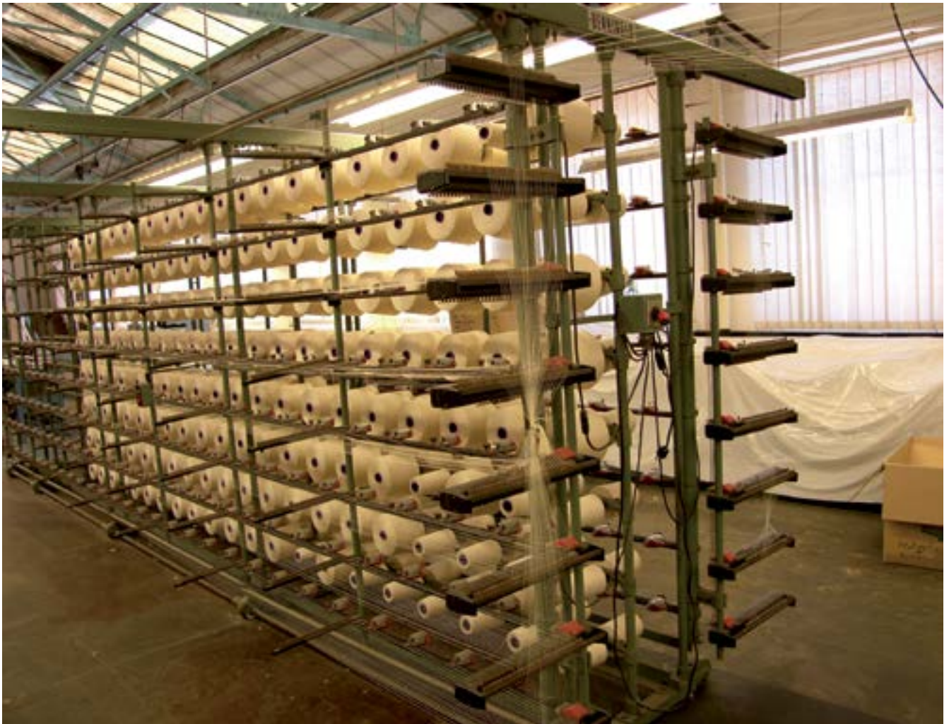
Warp creel for the creation of the warp beam Spulengatter für die Herstellung des Kettbaumes Cantre à bobineaux pour la fabrication de l'ensouple
