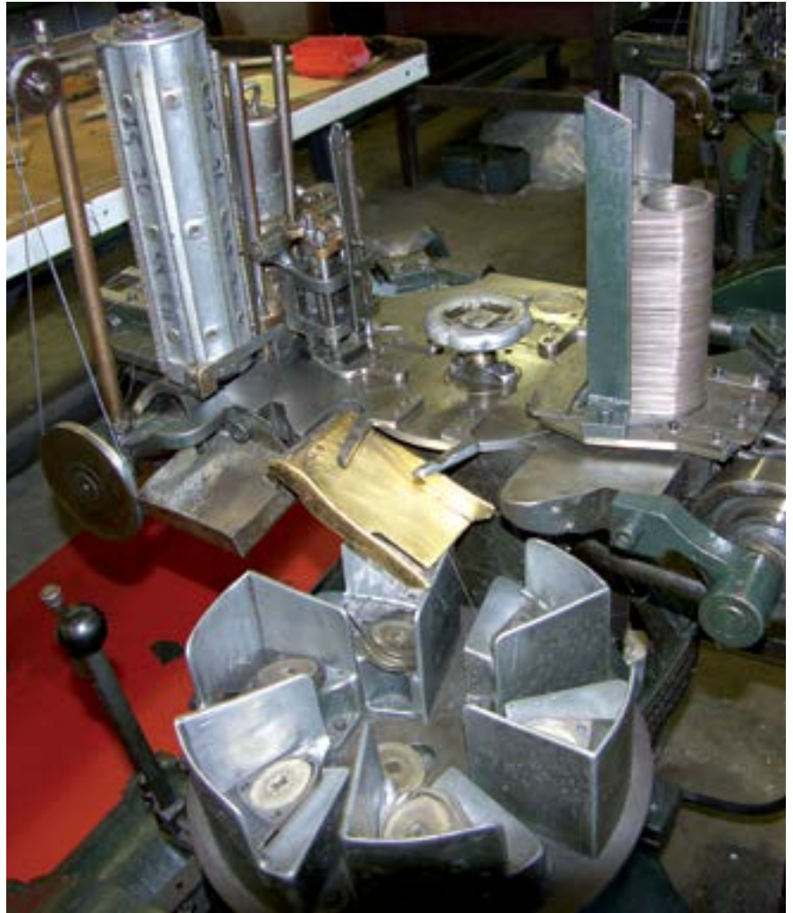
Insertion of the wound brass bobbins into the shuttles made of plate Einsetzen von gefüllten Bobinen (aus Messing) in die Schützen (aus Blech) Mise en place des bobines pleines (en laiton) dans les canettes (en tôle)
